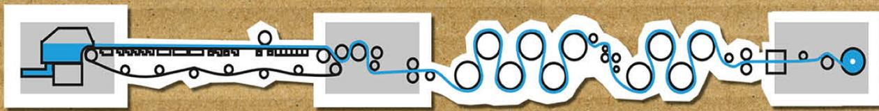
Der hoch verdünnte Faserbrei (1:99) wird auf ein umlaufendes Sieb gesprüht, Wasser fließt hindurch, wird abgesaugt und von Walzen herausgedrückt. Anschließend trocknet die Papierbahn zwischen dampf-beheizten Zylindern, wird geleimt, geglättet und aufgerollt.
